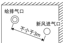
3. 两者不在同一水平高度，给排气口在下方时，应满足墙面水平间距 a 不小于 3m，或者墙面水平间距 a 与垂直间距 b 之和不小于 5m。
