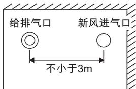
2. 两者不在同一水平高度，给排气口应尽量布置于新风进气口上方，给排气口在上方时，给排气口与新风进气口之间直线间距不小于 3m。
